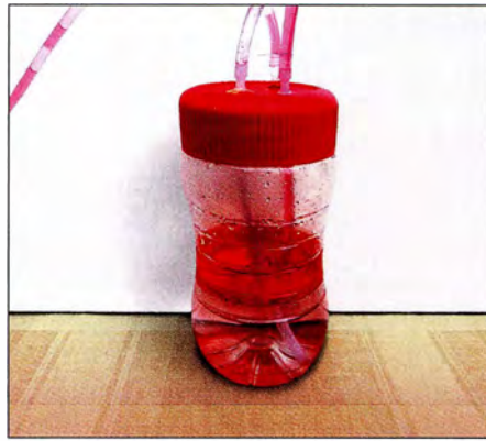
Bild 4: Im nicht zu klein zu wählenden Auf-fangbehälter trennen sich Paraffinöl und Wasser wieder. Fotos: Wendt
