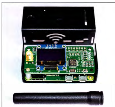
Jumbo-Spot mit Display in einem durch einen 3-D-Drucker erzeugten Kunststoffgehäuse; davor die Aufsteckantenne Werkfoto
