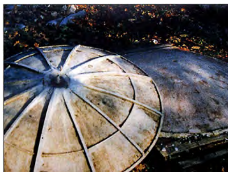
Bild 4: 1,5-m-Spiegel mit eingeklebten Aluminiumprofilen, rechts die Gipsform
