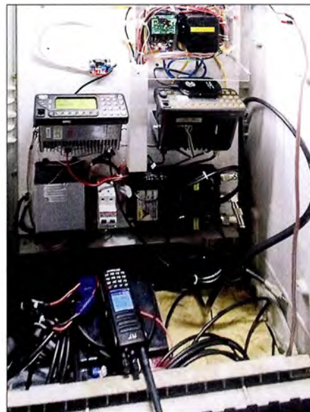
Blick in den Schaltschrank des MMDVM-Relais DB0USD mit den beiden verbauten Motorola-Funkgeräten GM1200E und GM1200 Foto: DO6UK
