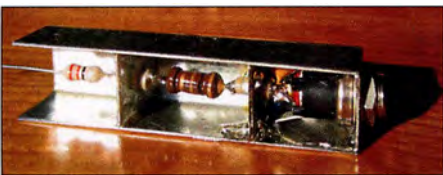
Bild 5: Filter für die Speisespannung des Leistungsverstärkers
