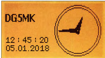
Bild 5: Die interne Echtzeituhr liefert den Zeitstempel für gespeicherte Messdaten.
