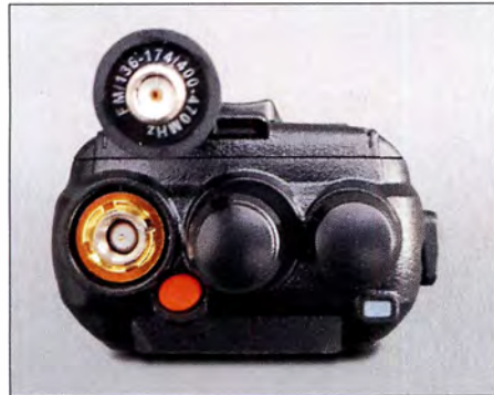
Reverse-SMA wie gewohnt: Der Antennenanschluss ist ein Stecker und die Antenne, hier von unten gezeigt, besitzt eine Buchse.
