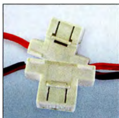
Bild 1: Diese Sicherungshalter bringen erhöhte Übergangswiderstände.
