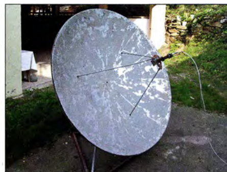
Bild 5: Satellitenempfangsanlage mit 1,5-m-Spiegel und aufgesetztem Empfangsmodul
